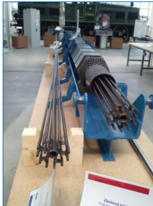
Model palivového souboru VVER-1000 s regulačními tyčemi
