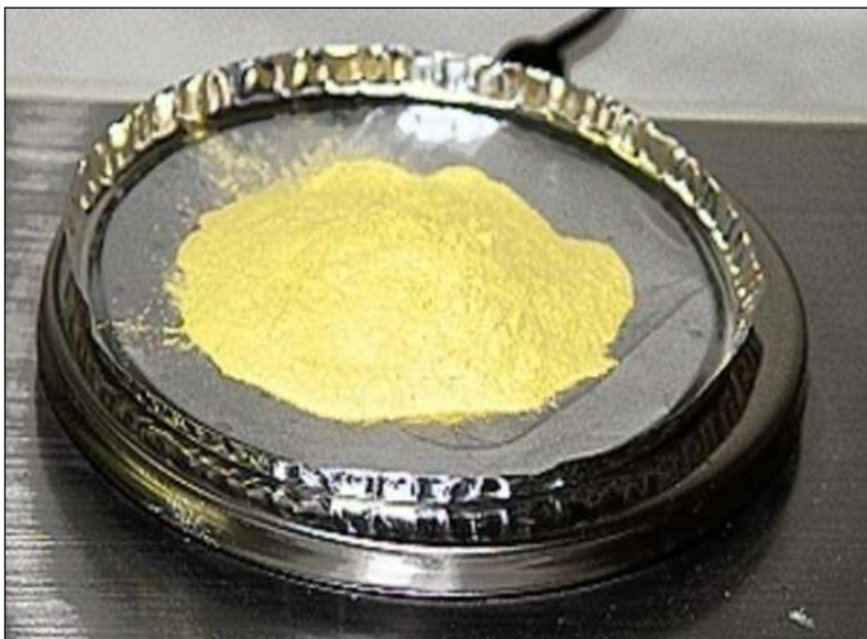
Žlutý koláč (diuranát amonný) – polotovár pro výrobu jaderného paliva (zdroj DIAMO, s.p.).
